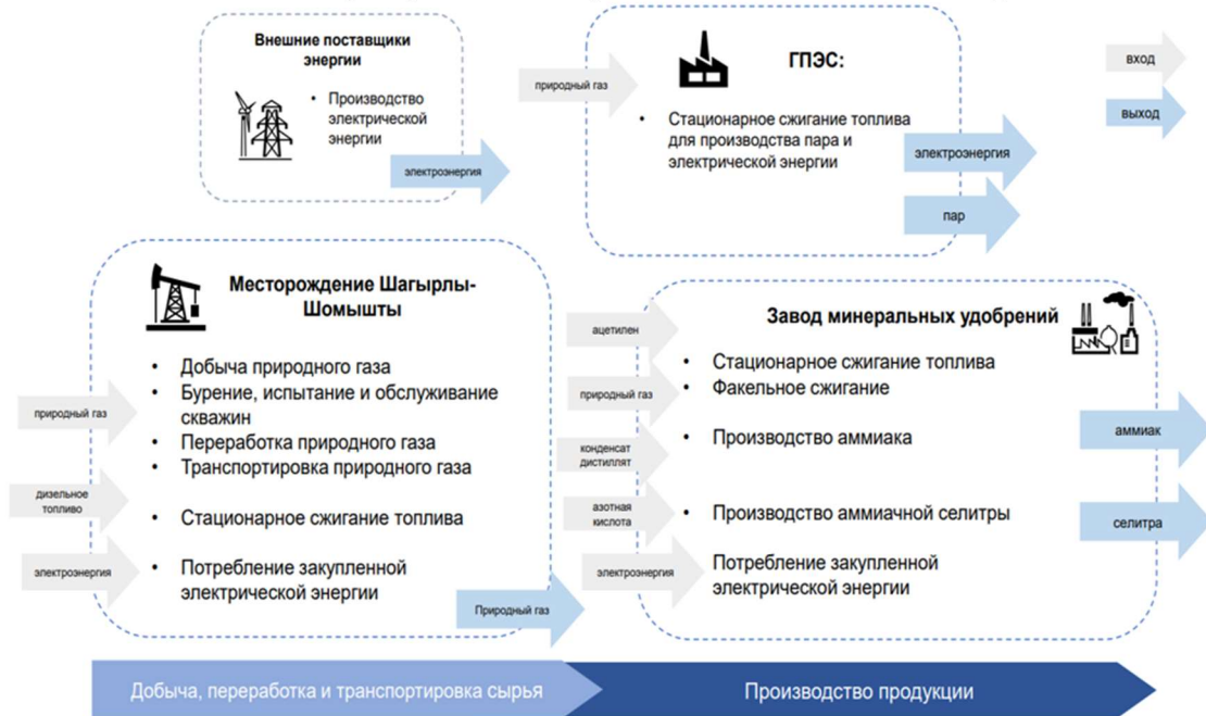
Рисунок 10. Блок-схема процессов, распределенных по стадиям жизненного цикла продукции и производственным подразделениям.
